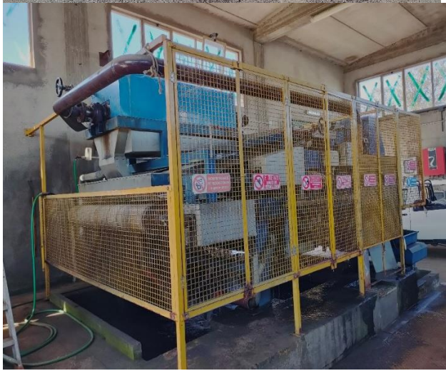
Vasca di ispessimento fanghi e nastropressa
